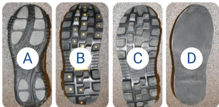
Nous avons testé les différentes bottes d'hiver en mesurant l'angle maximal sous lequel les semelles peuvent s'agripper à la glace lors d'une montée ou d'une descente.
