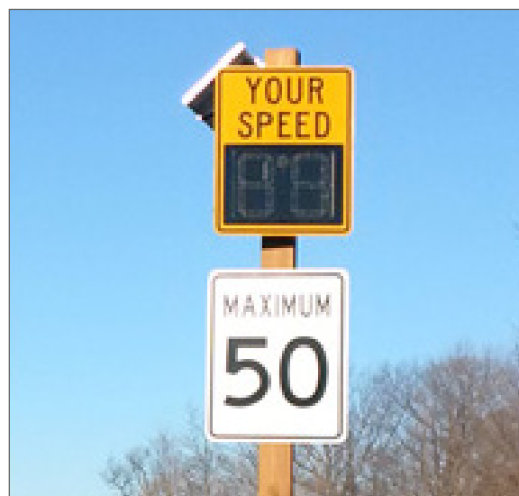
Figure 3: Exemple d'un panneau d'avertissement de vitesse
